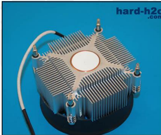
Figura 2.4. Bloque de disipación.
