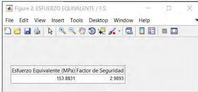
Figura 4.21. Esfuerzo máximo y factor de seguridad.
