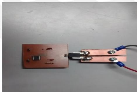
**Figura 4.9 Fotografía del circuito para medición de corriente**
