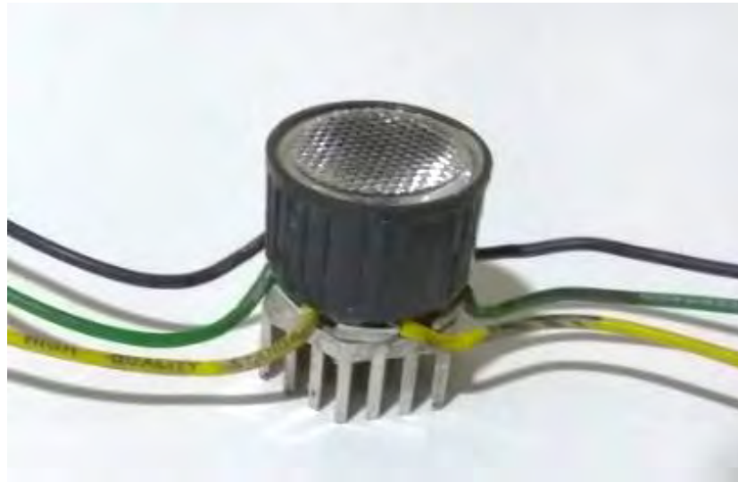
Figura 60 LED con el lente y disipador
