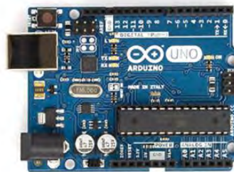
Figura 29 Arduino uno R3
