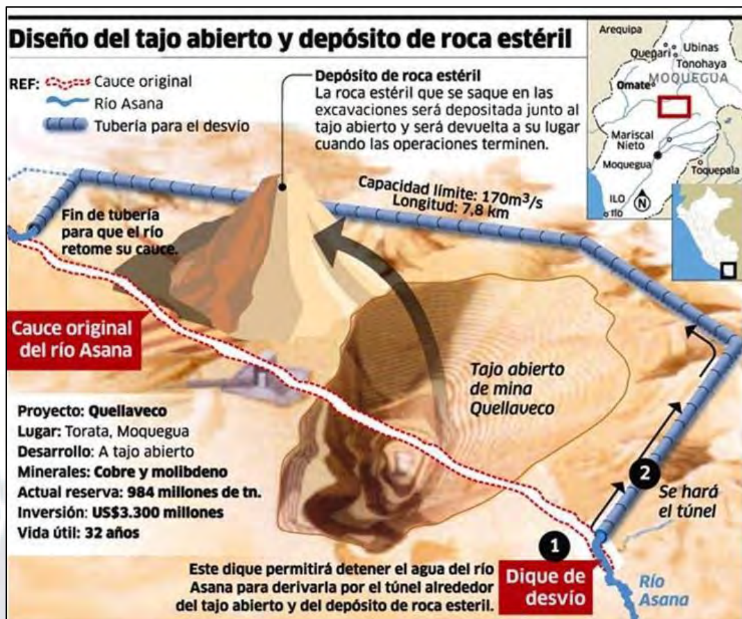
Figura 19. Diseño del tajo abierto y depósito de roca estéril. Tomado de “Asi se Forjó el Acuerdo de Moquegua con el Proyecto Minero Quellaveco”, por Diario La República, 2012, 10 de agosto. Recuperado de: http://www.larepublica.pe/10-08-2012/asi-se-forjo-el-acuerdo-de-moquegua-con-el-proyecto-minero-quellaveco
