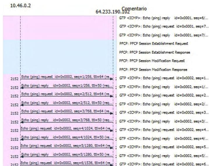
Figura 111. Flujo de tráfico por medio del protocolo GTP-U para el UE 2
