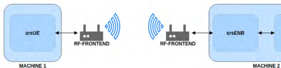
Figura 32. Implementación de escenario con interfaz aérea usando USRPs [22]
