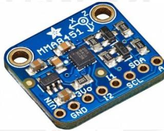
**Figura 3.2:** Tarjeta del acelerómetro MMA8451Q [27]
