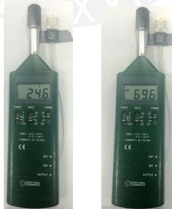
**Figura 4.7:** Calibración de sensor ambiental
