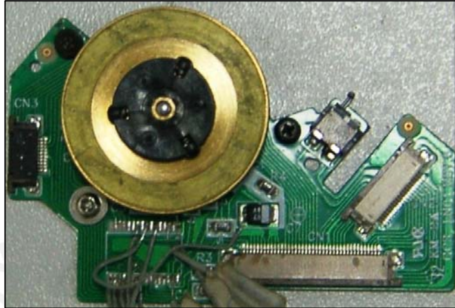
Figura 23.- Motor trifásico de lectora de DVD de laptop.
