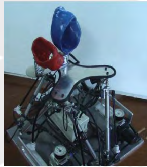
Figura 2.9 Dispositivo de rehabilitación usando mecanismos paralelos neumáticos 17
