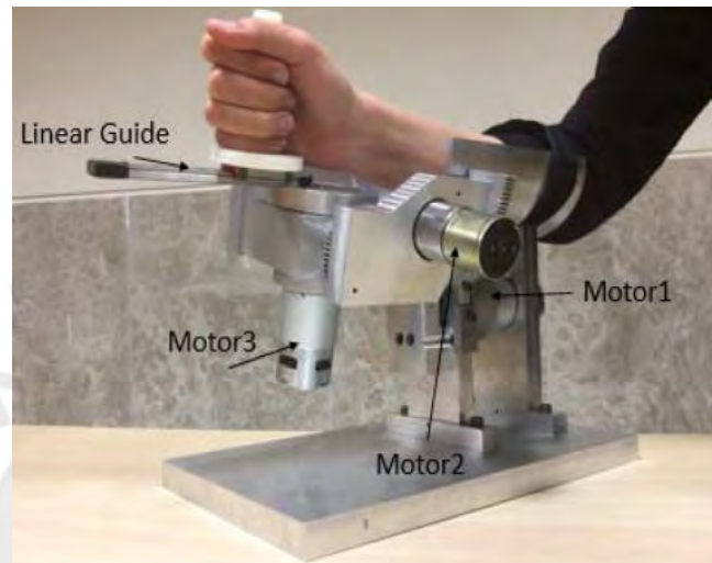
Figura 2.13 Dispositivo de rehabilitación de muñeca en 3GDL 21
