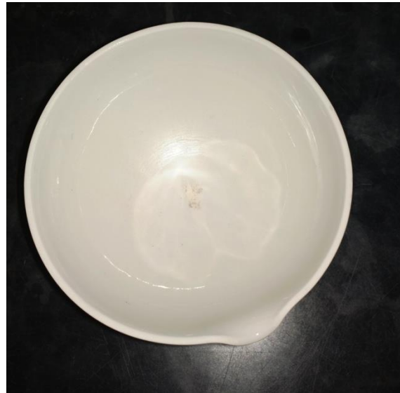
Figura 17. Determinación de sólidos totales. Cápsula luego de la evaporación de la muestra. Fuente: Propia
