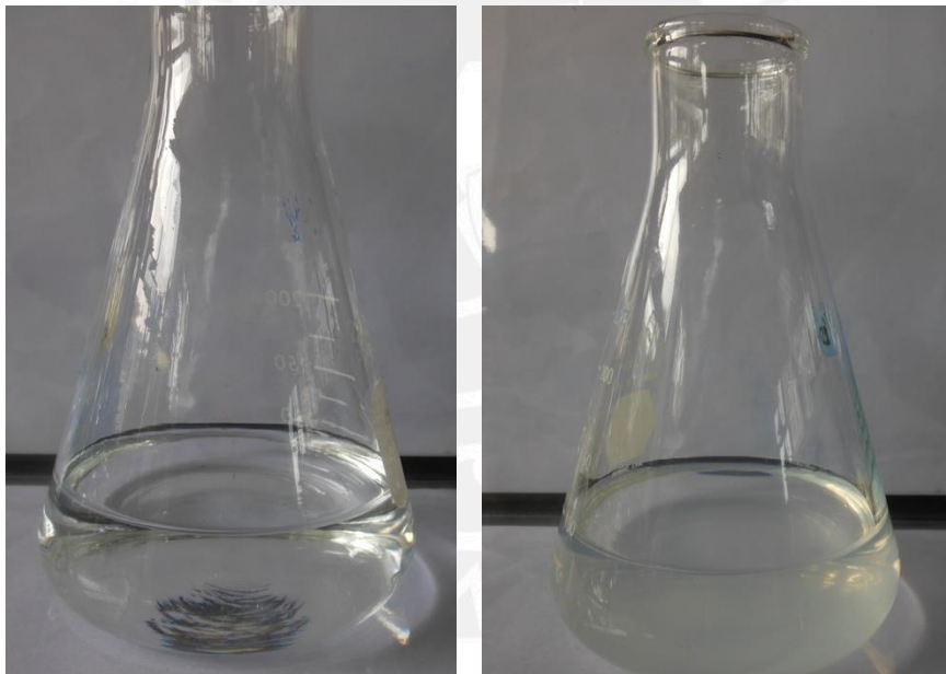
Figura 24. Determinación de sulfatos. Muestra antes de agregar el \text{BaCl}_2 (izquierda) y después de agregar la sal (derecha). Fuente: Propia
