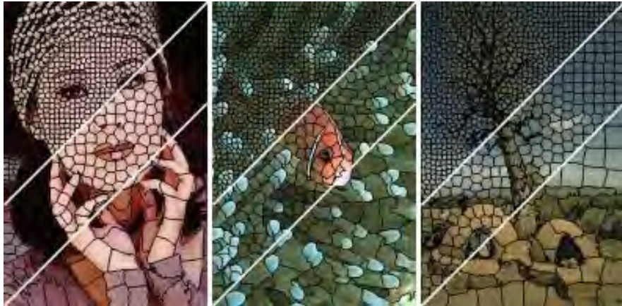
Figura 3.1: Imágenes segmentadas usando SLIC con 64, 256 y 1024 super píxeles
