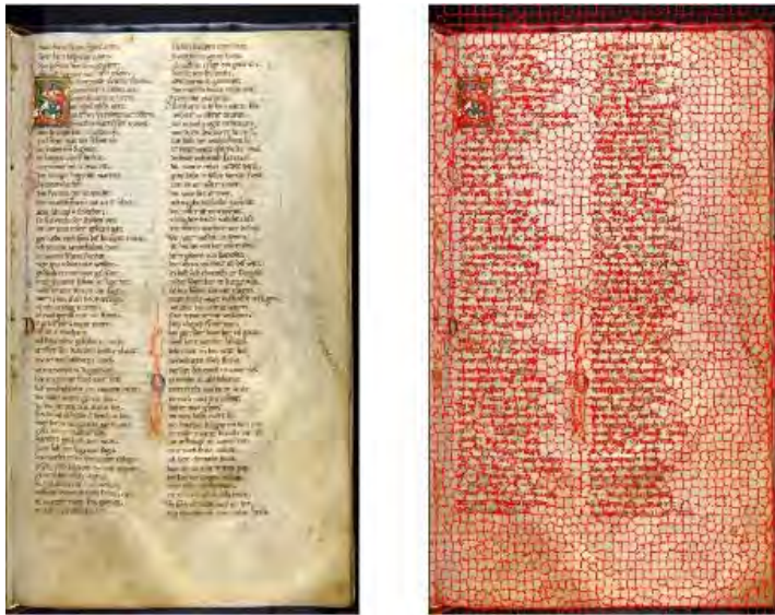
Figura 4.2: Imagen de documento histórico dividido en super píxeles. Izquierda, la imagen original. Derecha, la imagen segmentada en super píxeles (cada segmento está con borde de color rojo).
