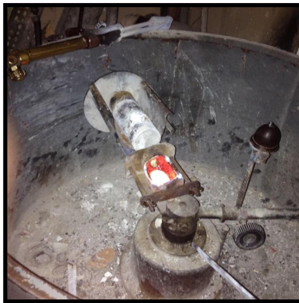
Figura 4.29 Inicio del vertido de metal fundido
