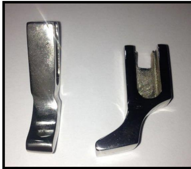
Figura 3.34. Pulido y niquelado, Pieza 1
