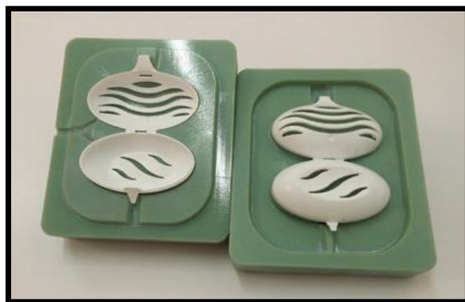
Figura 2.6 Moldes de material termoplástico ABS. [22]
