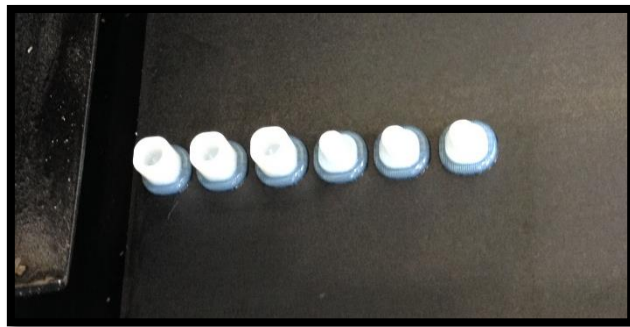
Figura 4.9. Cilindro macho y hembra para hallar el ajuste experimentalmente.
