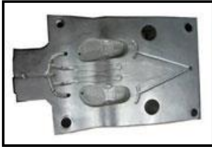
Figura 2.5 Molde para inyectado de suela de zapato obtenido por mecanizado. [21]
