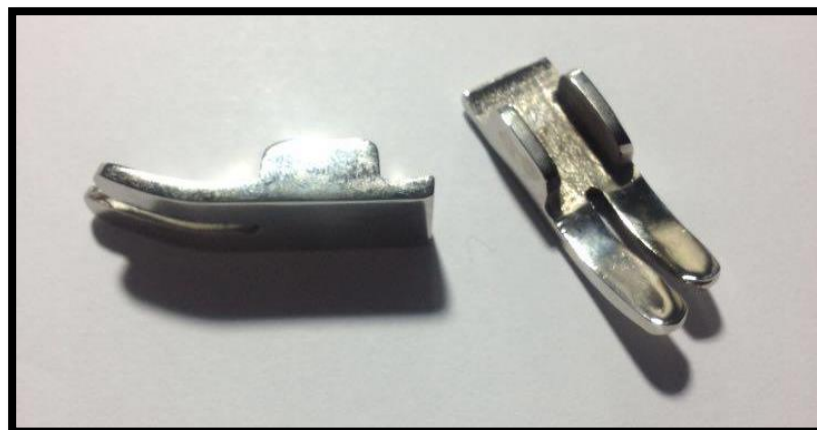
Figura 3.35. Pulido y niquelado, Pieza 2
