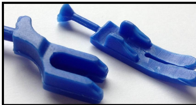
Figura 4.15. Piezas de cera con problemas de llenado incompleto.
