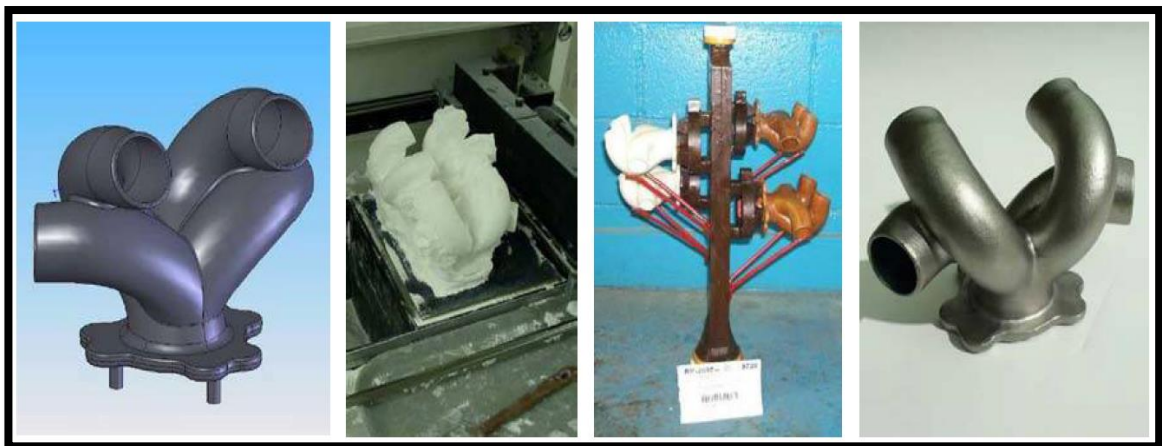
Figura 1.16. Procesos de fundición por revestimiento con tecnología de impresión en tres dimensiones. [11]
