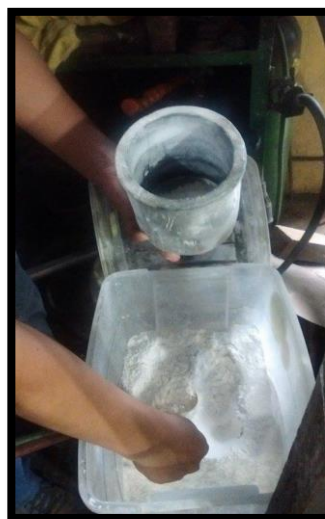
Figura 4.19. Preparación de la mezcla de agua y revestimiento.
