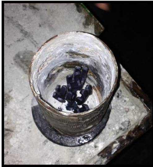
Figura 4.21. Preparación del recipiente cilíndrico con el árbol de cera.
