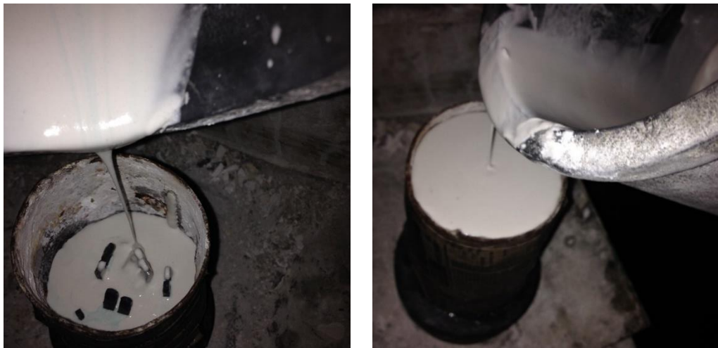
Figura 4.23. Vertido de la mezcla agua-revestimiento al cilindro que contiene el árbol de cera.
