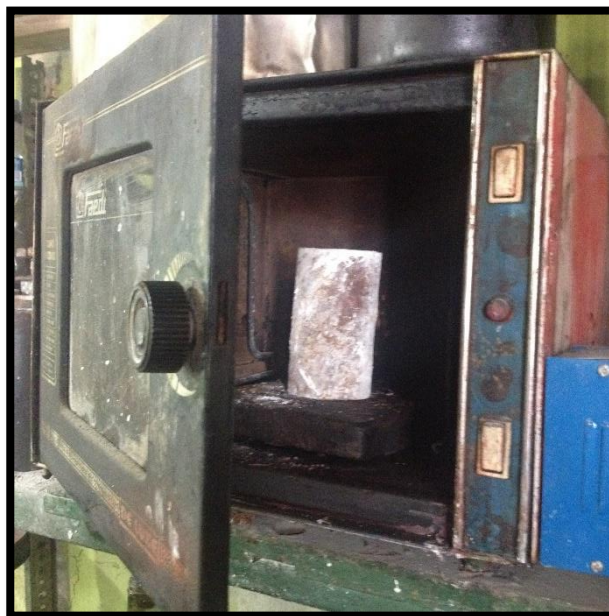
Figura 4.25. Molde de yeso en el horno para fundir y evacuar la cera.
