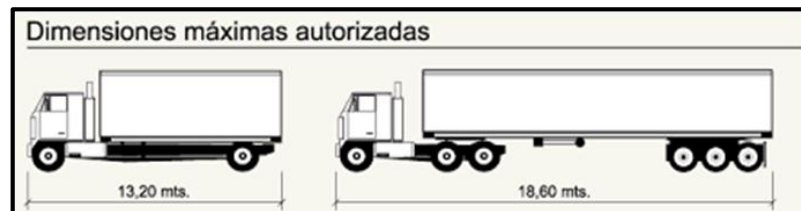
Ilustración 43. Dimensiones de un camión de consumo masivo Fuente: Gym Logistic 2015
