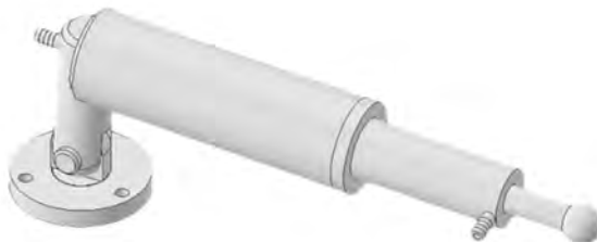
Figura 4.2: Modelo CAD de Pistón Telescópico de doble efecto
