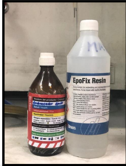
Figura 11: Compuestos necesarios para la obtención de una buena sección pulida: resina EpoFix (derecha) y endurecedor (izquierda).
