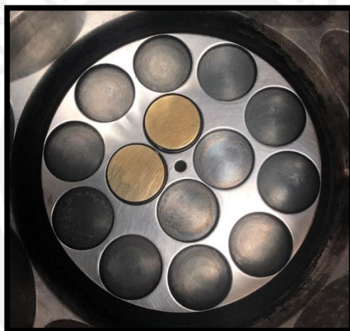
Figura 20: Portamuestra que se introduce al interior del grafitizador "Emitech K950X".
