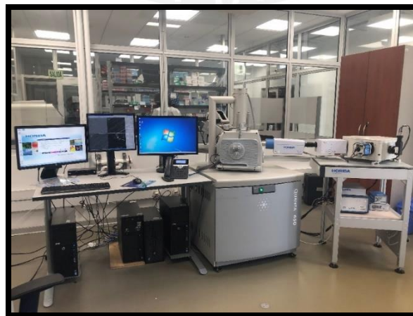
Figura 16: Microscopio electrónico de barrido ambiental Quanta 650 FEI (SEM).
