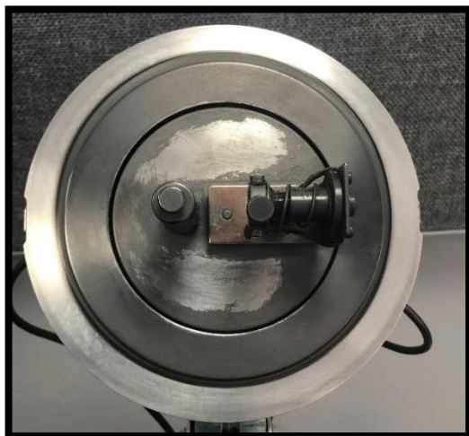
Figura 19: Zona superior del equipo donde se introducirán las pequeñas barras de grafito.
