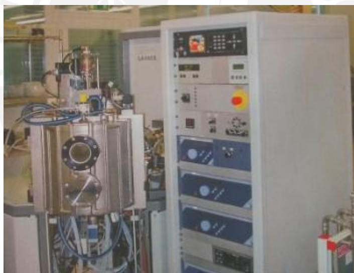
Figura 23. Equipo de pulverización catódica LA440S usado para la obtención de las películas delgadas ubicado en el Instituto de Micro y Nanotecnología (IMN) de la Universidad Tecnológica de Ilmenau (TU Ilmenau) en Thuringen, Alemania.
