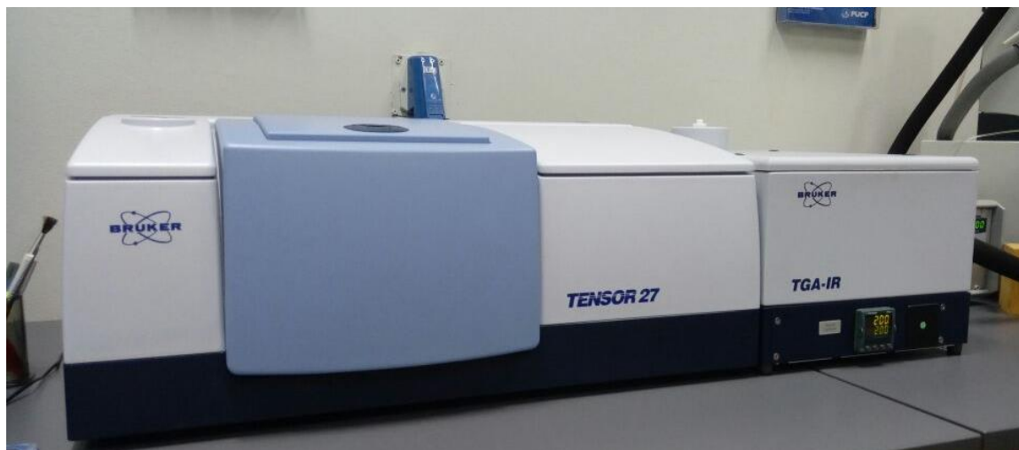
Figura 25. Equipo de FTIR (Bruker Tensor 27) usado para la caracterización de las películas delgadas depositadas en la PUCP.
