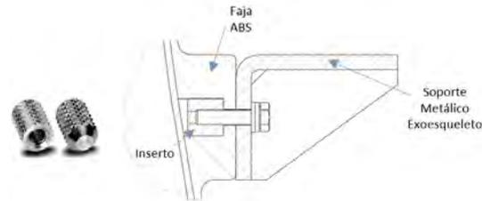
Figura 44. Detalle unión faja ABS con Soporte de Exoesqueleto
