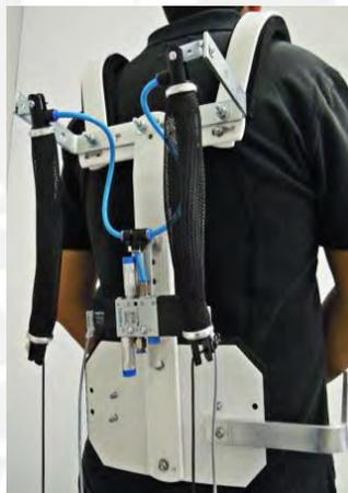
Figura 6: Exoesqueleto con músculos neumáticos (8)
