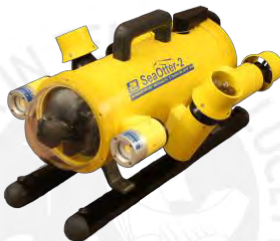
Figura 1. 7: MiniROV de exploración Seaotter 2.0 Fuente: JW Fishers
