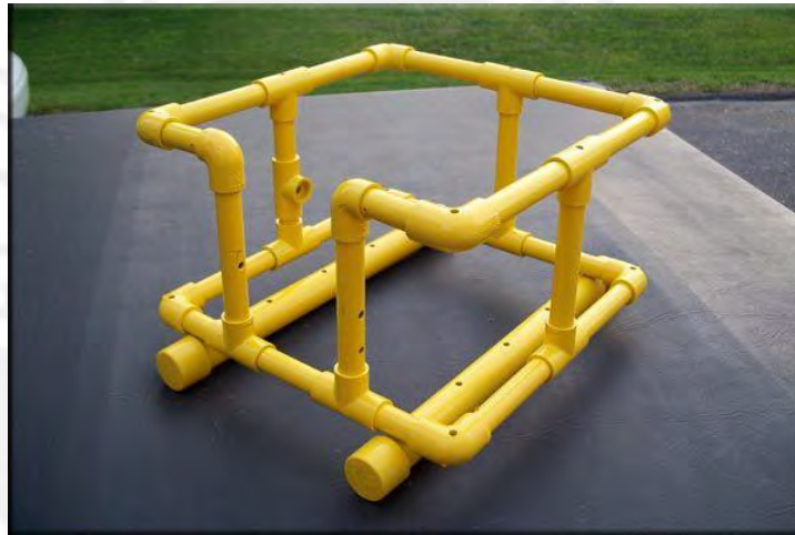
Figura 1. 4: Marco de un ROV de exploración hecho con tubos de PVC. Fuente: Askix
