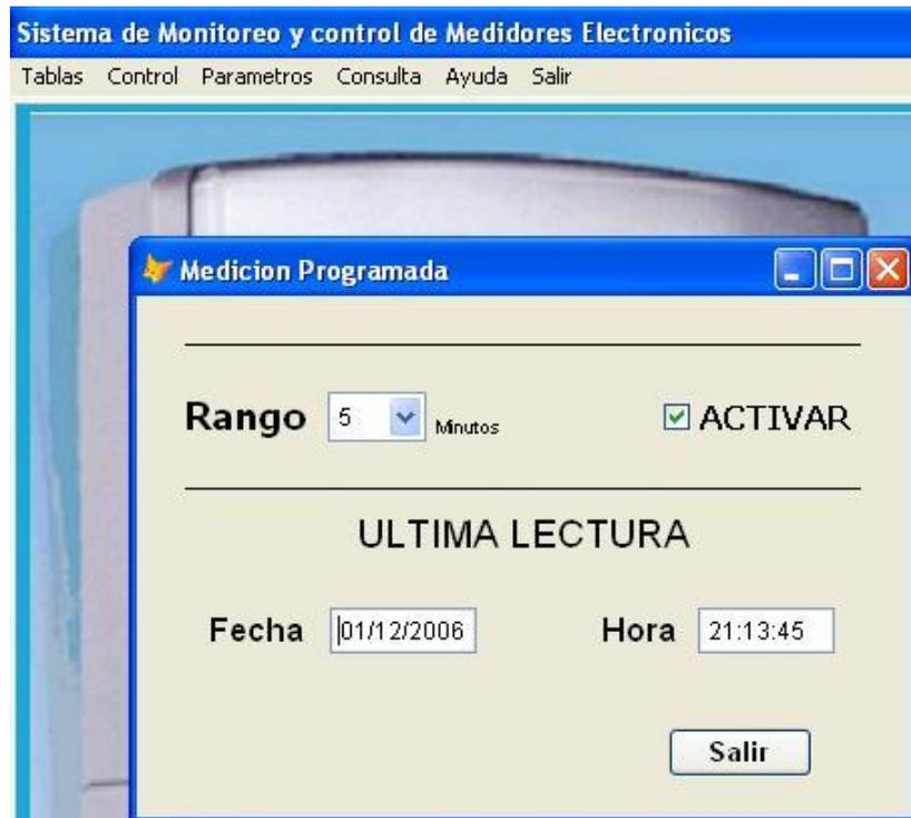
**Figura 22:** La imagen muestra la pantalla del software de interfaz de usuario que permite establecer el intervalo de tiempo en los que se realizara una adquisición de datos o medición programada.
