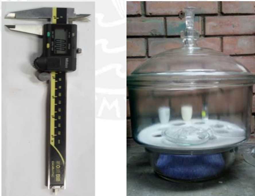
Figura N° 23. Vernier digital Mitutoyo 500-196-30B (izquierda) y Desecador de laboratorio (derecha)
