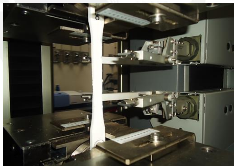
Figura N° 26. Ensayo de tracción a una probeta de Kevlar en el equipo de Tracción Universal Zick/Roell Z750
