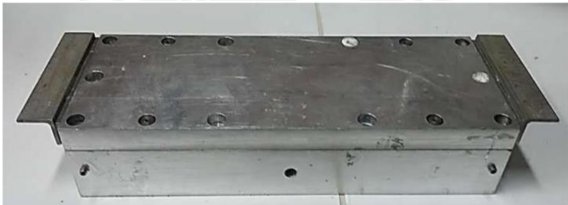
Figura N° 21. Partes del molde de ALUMOLD empleado para la fabricación del material compuesto (Superior) y el molde completamente cerrado (inferior).
