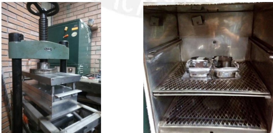
Figura N° 38. Prensado del molde (izquierda) antes de la etapa de curado dentro del horno (derecha)
