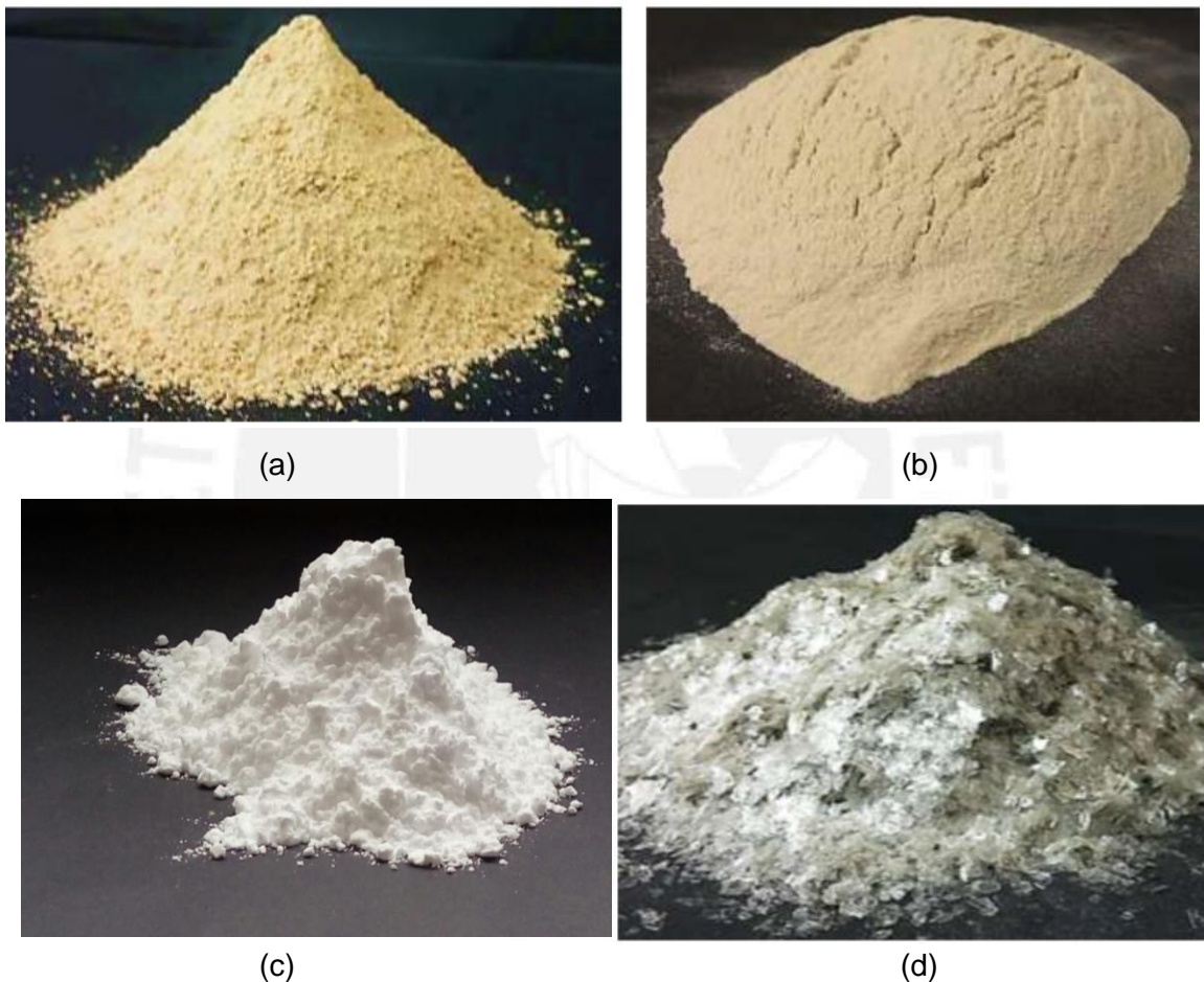
Figura N° 16. Cargas minerales no metálicas. (a) Marmolina, (b) Polvo de cuarzo, (c) Trihidróxido de aluminio (ATH) y (d) Mica fina.
