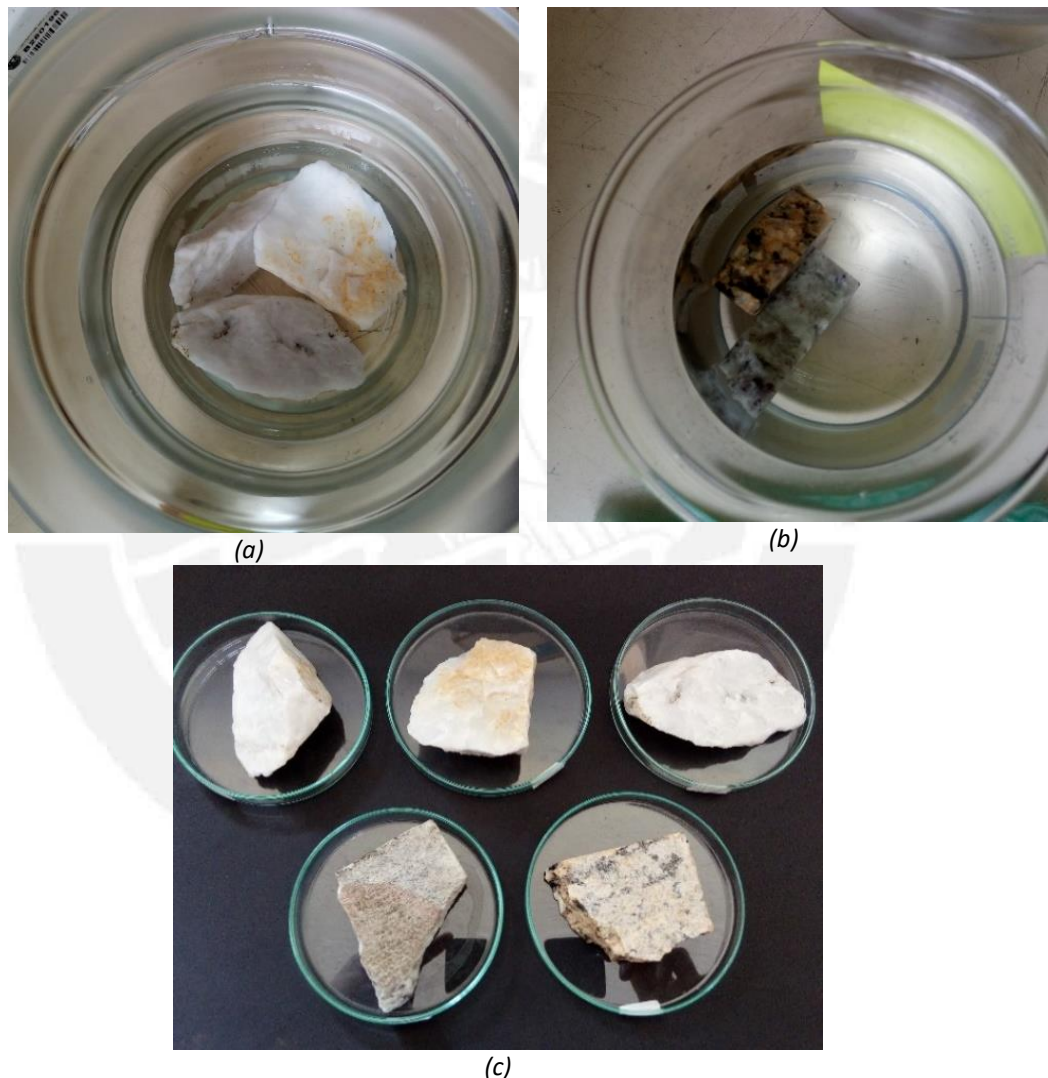
Figura N° 34. Muestras de cuarzo (a) y granito (b) inmersas en agua destilada; figura (c) se tienen las muestras empleadas en el ensayo (cuarzo parte superior y granito parte inferior).
