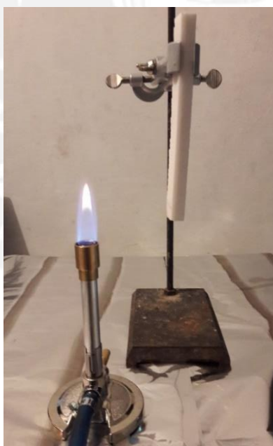
Figura N° 31. Montaje del equipo empleado para el análisis de la resistencia al fuego.
