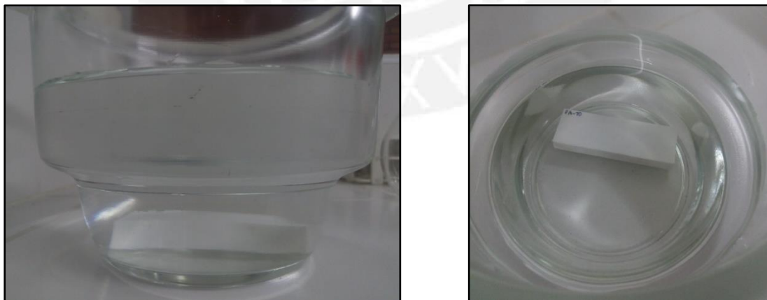
Figura N° 32. Ensayo de absorción de agua, probeta sumergida en agua por 24 horas.
