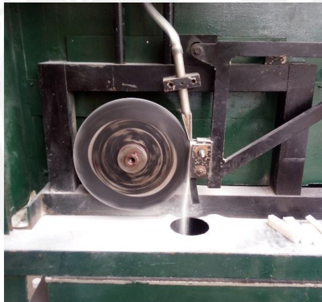
Figura N° 29. Equipo de resistencia al desgaste en pleno ensayo.
