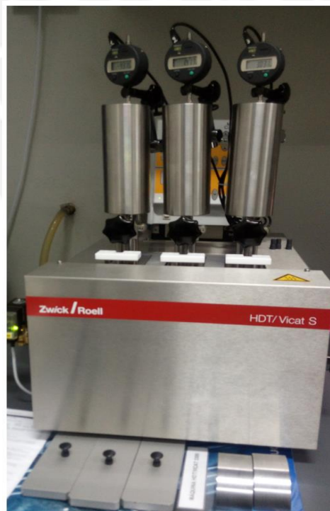
Figura N° 30. Equipo Vicat S, empleado para el ensayo HDT y VICAT.
