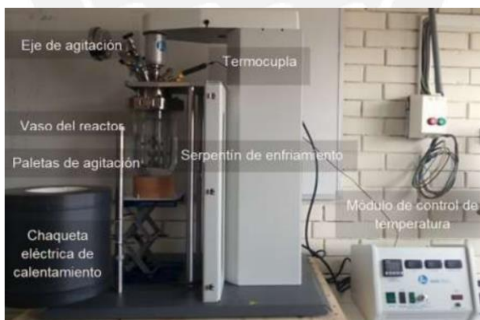
Figura N° 20. Reactor y controlador Parr empleado para la síntesis del jarabe.
