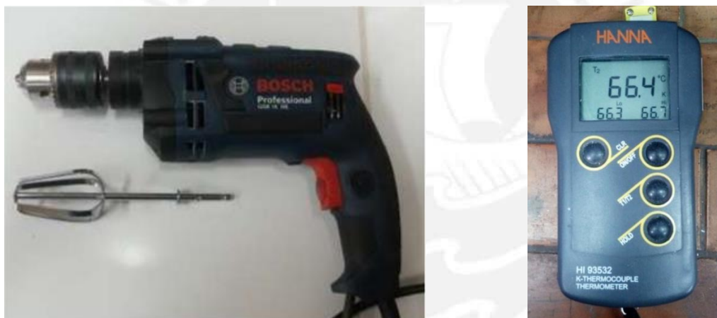
Figura N° 22. Taladradora manual empleado para la mezcla del material compuesto (izquierda) y Termocupla de contacto tipo k (derecha).
