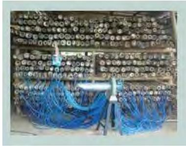
Fig. 10: Inyección de aire caliente. Fuente: construir con Bambú, “caña Guayaquil”
