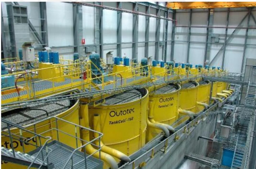
Fig. 2.7. Circuitos de celdas de flotación.
