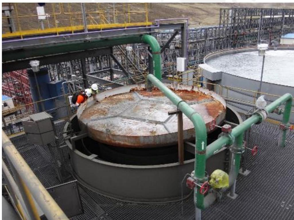
Fig. 4.12. Sistema de agua de lavado de la celda columna.
