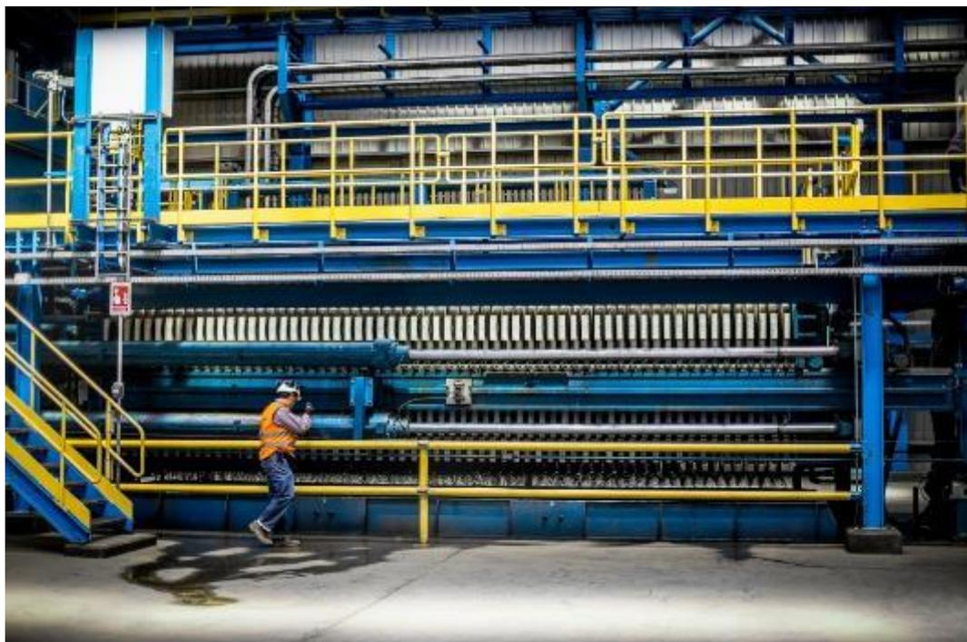
Fig. 2.14. Filtro prensa VPA de Metso.
