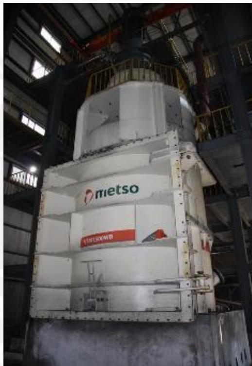
Fig. 2.10. Molino vertical VTM.
