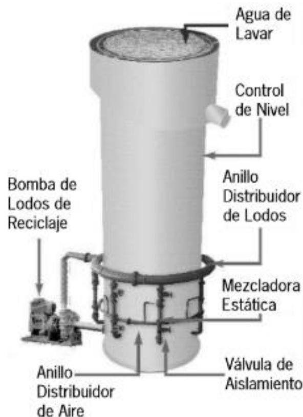
Fig. 2.11. Celda de flotación tipo columna.
