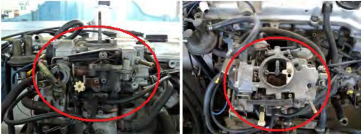
Figura 2.2. Carburador del motor Nissan GA15 de marca Hitachi. <sup>2</sup>
