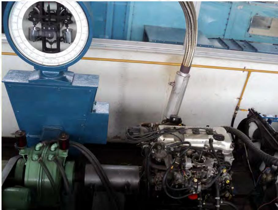
Figura 2.1. Banco de ensayo del motor Nissan GA15 del Laboratorio de Energía.<sup>1</sup>
