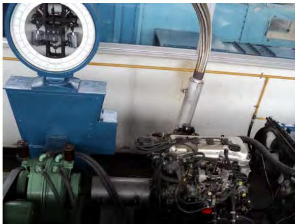
Figura 4.5. Banco de ensayos en donde se implementará el sistema de control.
