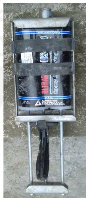
Fotos 13, 14, 15, 16 y 17. Materiales para unir elementos metálicos de refuerzo y para fijarlos al pórtico: Electrodo de soldadura, Gel epóxico para sujeción de anclajes y Sistema de inyección (de aplicación)
