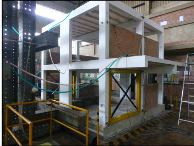
Figura 8.26: Post Fase 2: Módulo 780 - Pre reforzado
