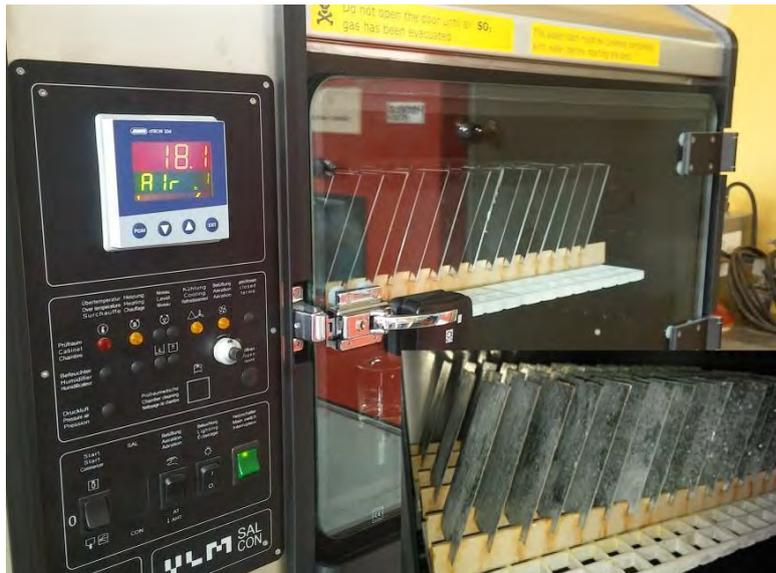
Figura 18. Ensayo de envejecimiento en progreso en la cámara de  $SO_2$ .
