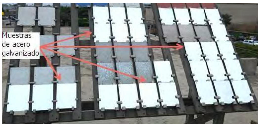
Figura 16. *Inicio del ensayo de envejecimiento natural en el ICP-PUCP.*
