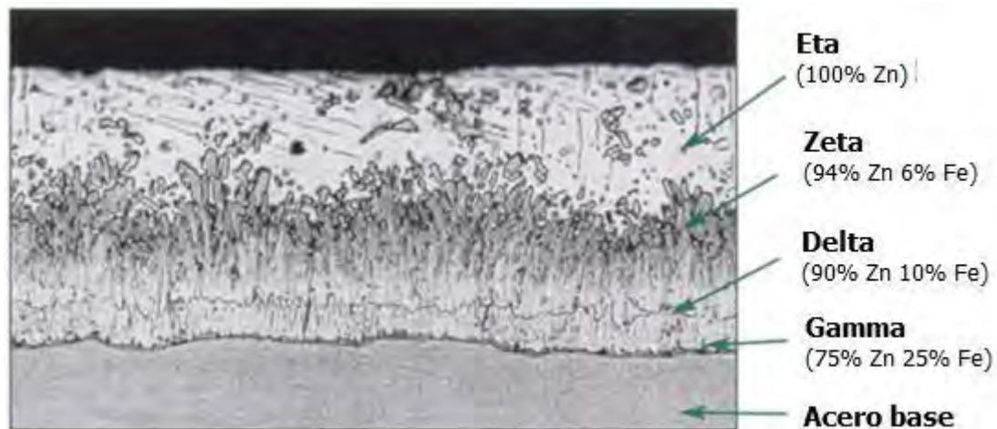
Figura 3. Micrografía de las capas intermetálicas de un convencional acero galvanizado obtenido por inmersión en caliente. Adaptado de GAA (2012).
