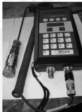
Figura 2.4: Recolector de datos conectado a un acelerómetro analógico.
