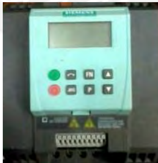
Figura 3.3: Variador de velocidad del motor.
