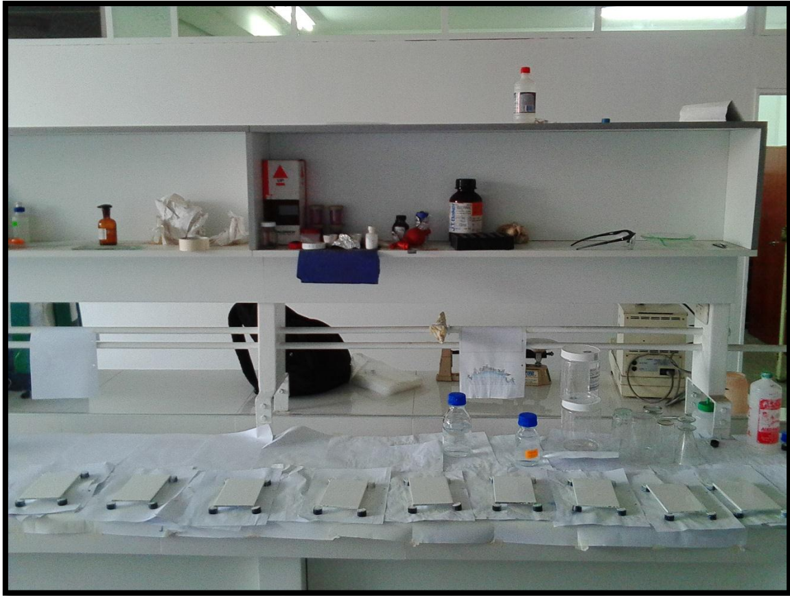
Figura 32. Probetas de acero, después del sistema de pintado.
