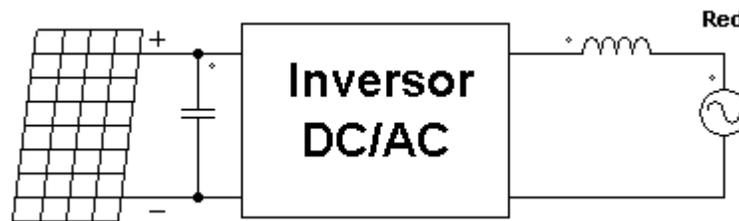
Figura 1.2: Inversor de una etapa con PV conectado a la red
