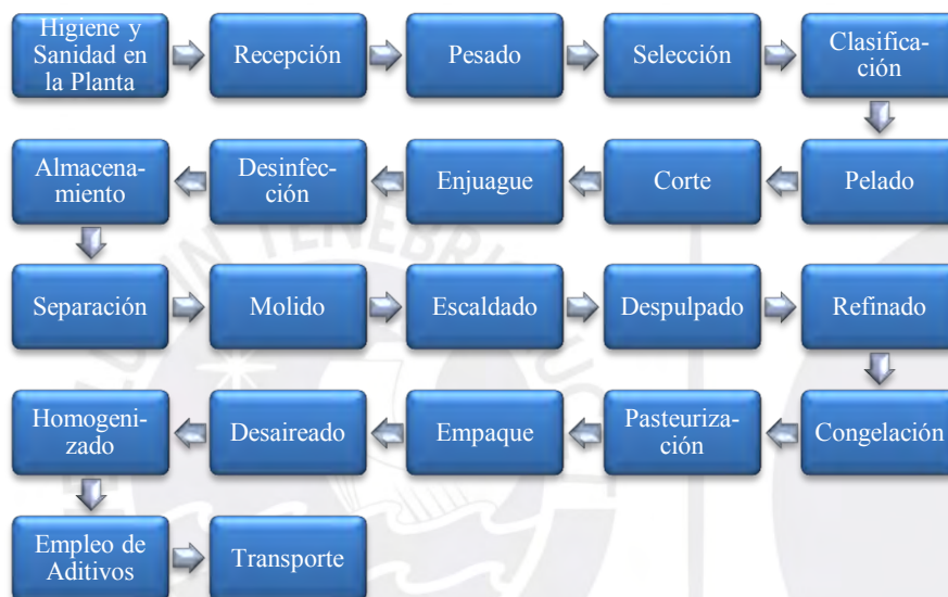
Figura 75. Flujo del Proceso productivo de la pulpa de mango congelado para el mercado internacional.
