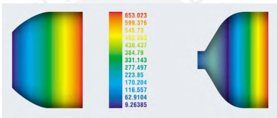
Fig. 1.7 – Simulación de un cilindro de GNV para mejorar su desempeño ( http://www.cilbras.com.br ).
