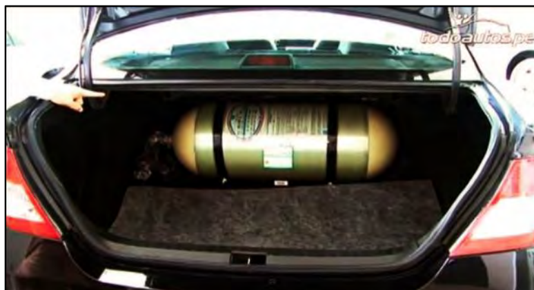
Fig. 1.2. Ubicación del tanque de GNV ( http://www.todoautos.com.pe/portal/auto/gnv-glp/2308-gnv-pesado-auto )
