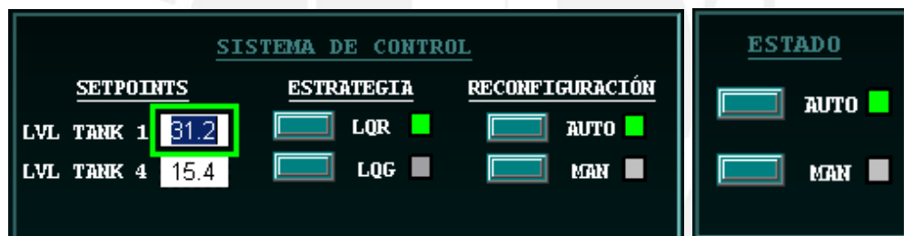
(a) Setpoints, ley de control y reconfiguración ante fallos
