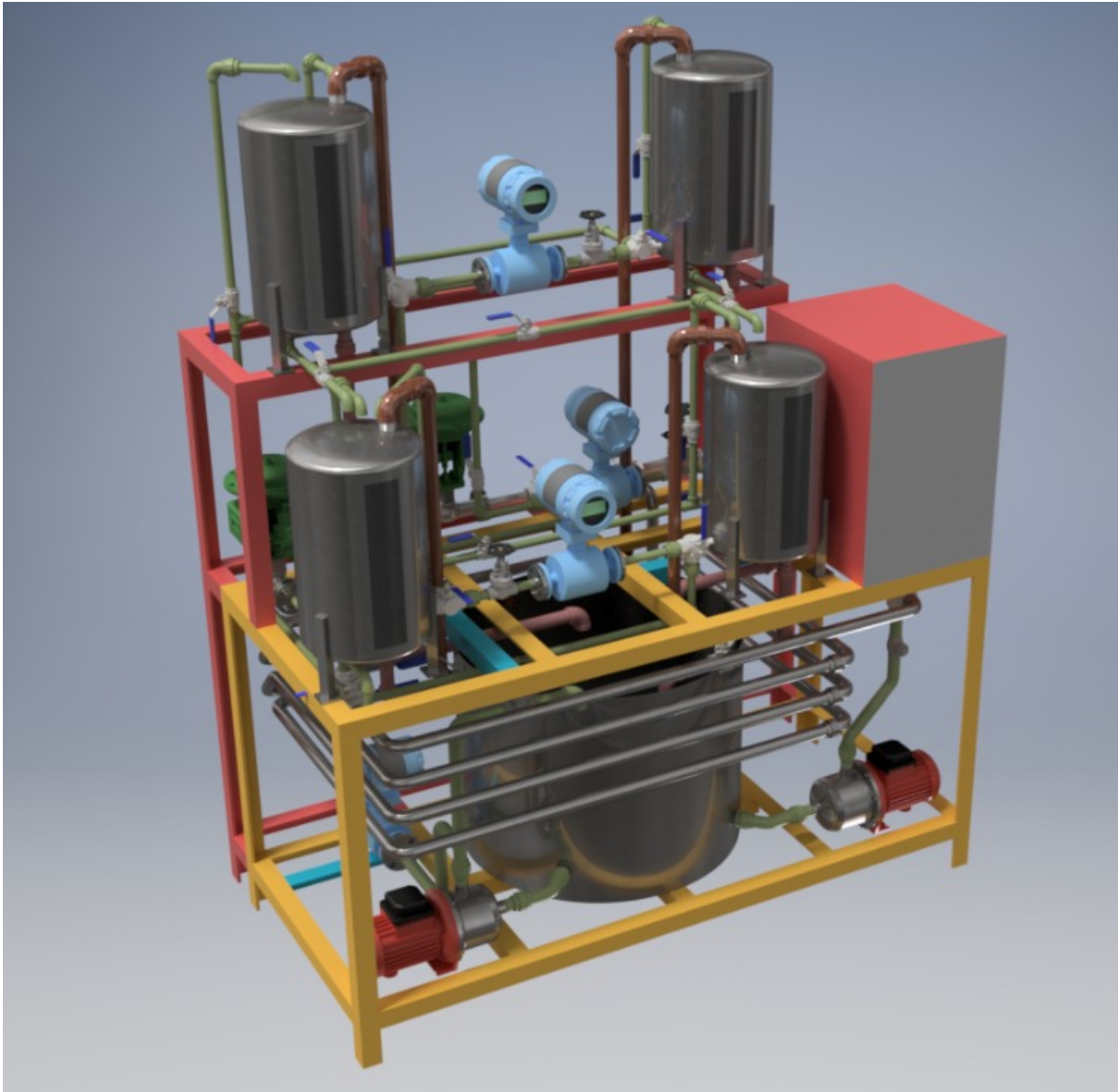
Figura 2.10: Planta piloto para investigar técnicas de FD y FTC en Sistemas con Tanques Interconectados. Fuente: MICA-PUCP
