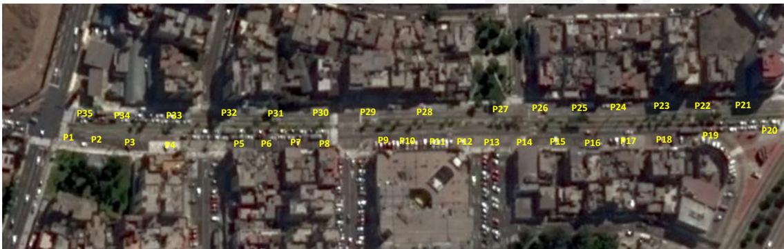
Figura 19: Puntos de medición de la intensidad de señal de los AP en la Av. La Mar. Fuente: Elaboración propia sobre imagen de Google Earth.
