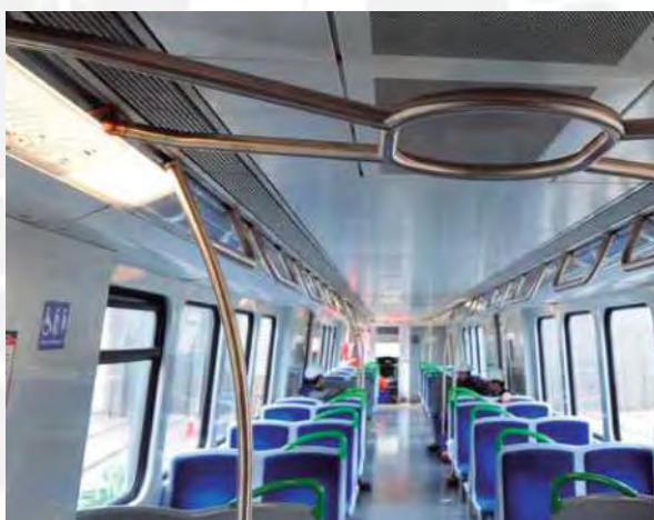
Figura 18. Transporte público (Primer tren con cobre antimicrobiano en Valparaíso). Tomado de: Instalaciones de cobre antimicrobiano en el mundo, 2015.
