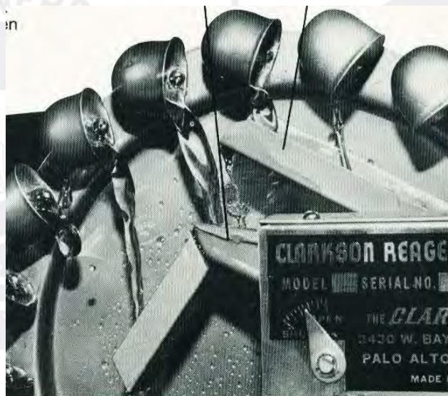
Figura 27. Dosificador de "Copas" Tomado del Archivo Fotográfico de Clarkson Reagent Company (USA)
