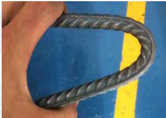
*Figura 73.* Barra luego de prueba de doblado.
