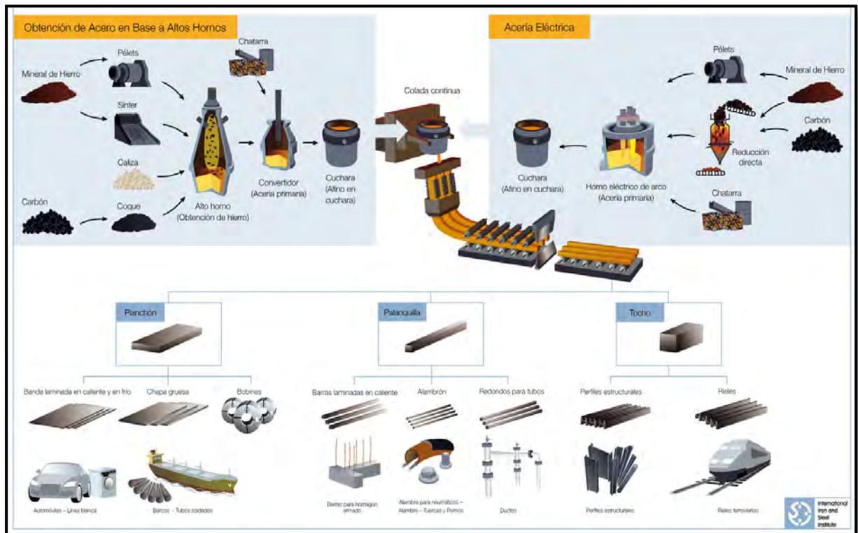
Figura 20. Productos fabricados por Empresa del Acero S.A., y su proceso de fabricación. Adaptado *Fabricación y procesamiento del acero*, por Weldg, 2013. Recuperado de <https://goo.gl/vTMbMg>
