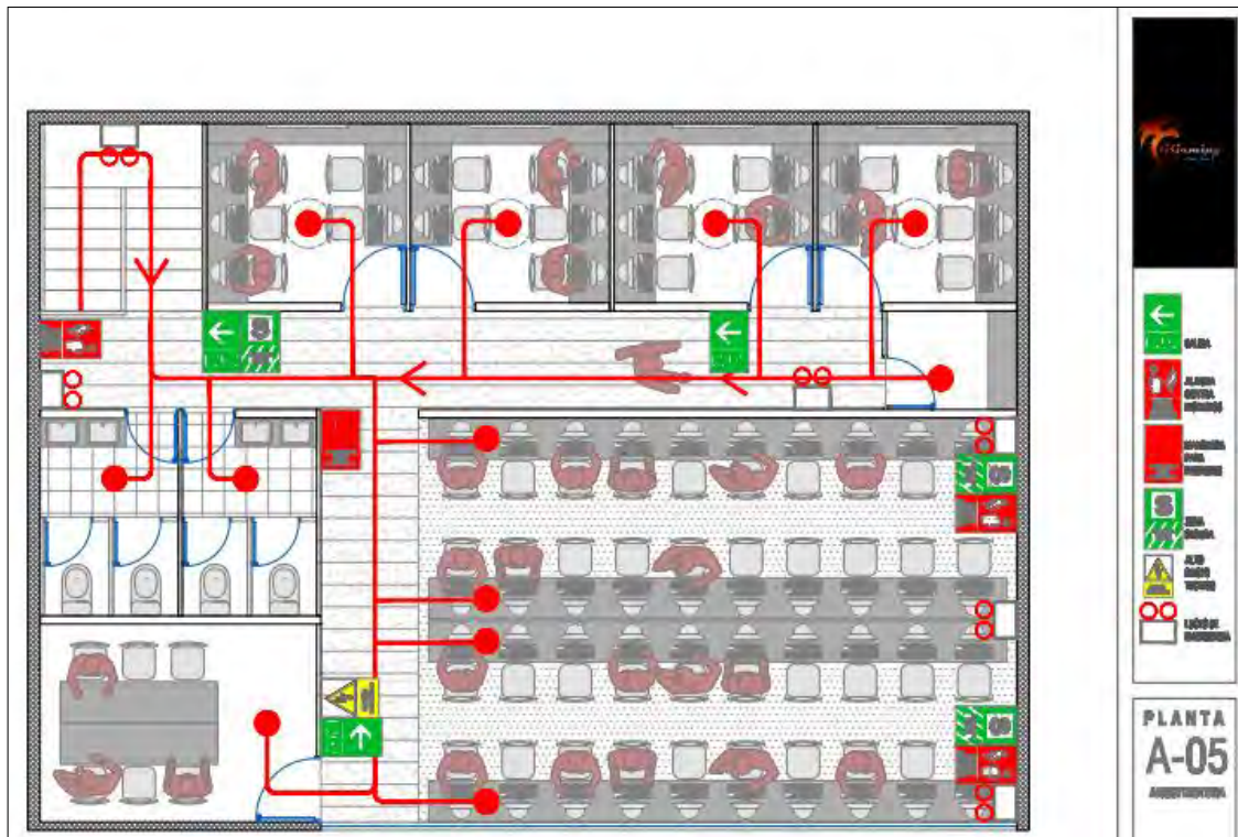
Figura 27: Plano de evacuación del segundo piso
