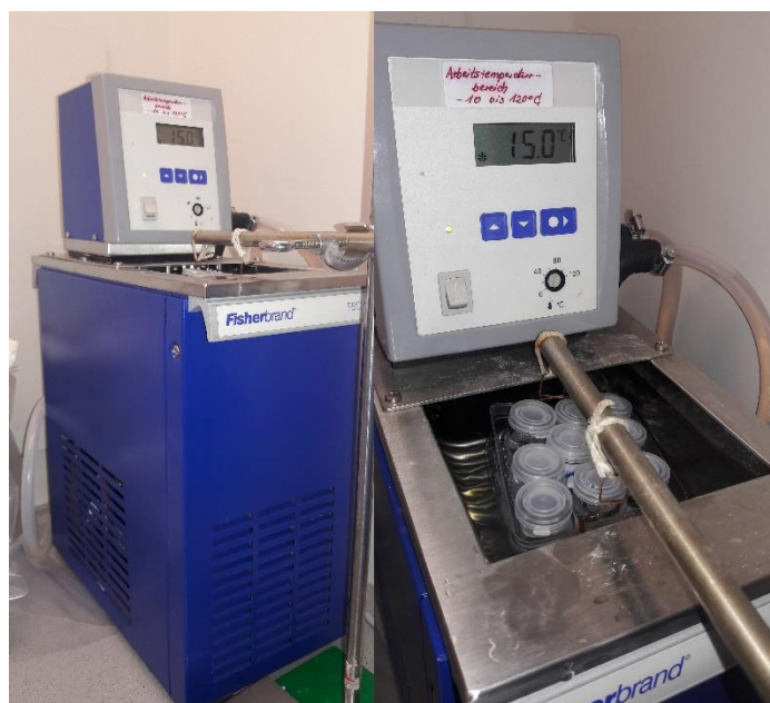
Figura 46. Baño termostático para mediciones de la termosensibilidad de los hidrogeles HGSD, Laboratorio de Polímeros Bioactivos y Sensibles del IPF.
