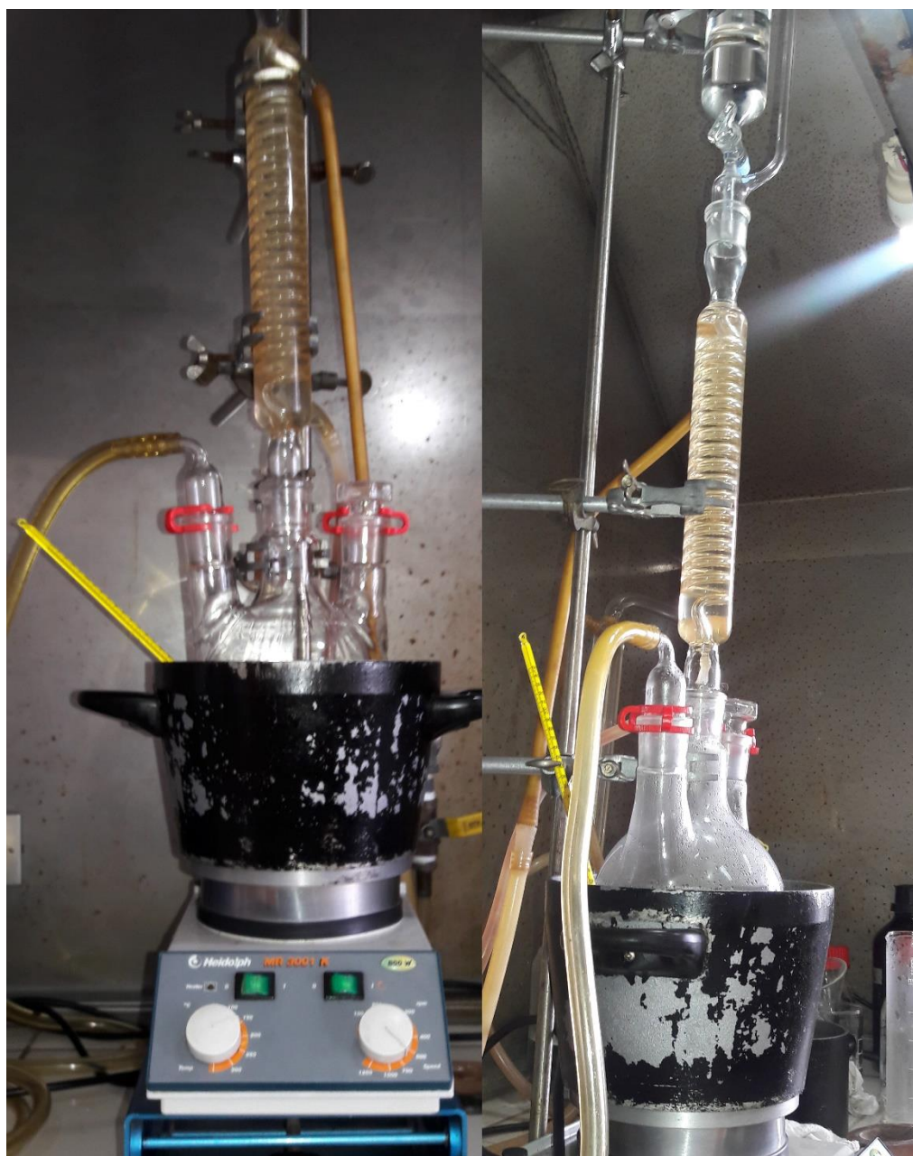
Figura 38. Sistema de reacción utilizado para síntesis del monómero 2-Ciclopropil-2-oxazolia (Cicloxa), Laboratorio de Polímeros Sección Física PUCP.
