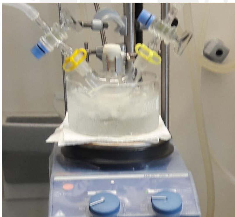
Figura 43. Sistema para síntesis de hidrogeles HGSD, Laboratorio de Polímeros Bioactivos y Sensibles del IPF.
