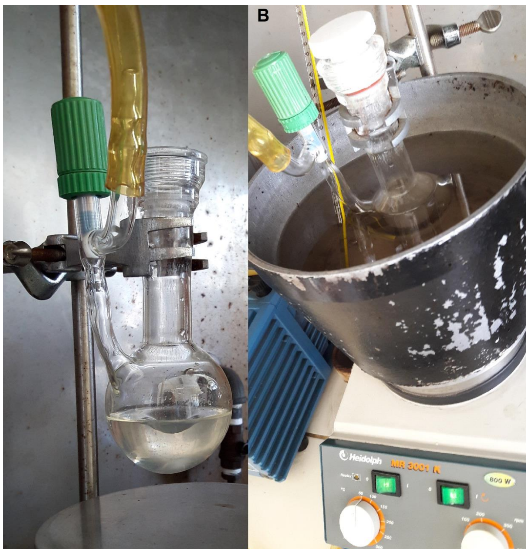
Figura 39. A. Preparación del sistema de reacción para la síntesis del macromonómero; B. Sistema de reacción para la síntesis del macromonómero, Laboratorio de Polímeros Sección Física PUCP.
