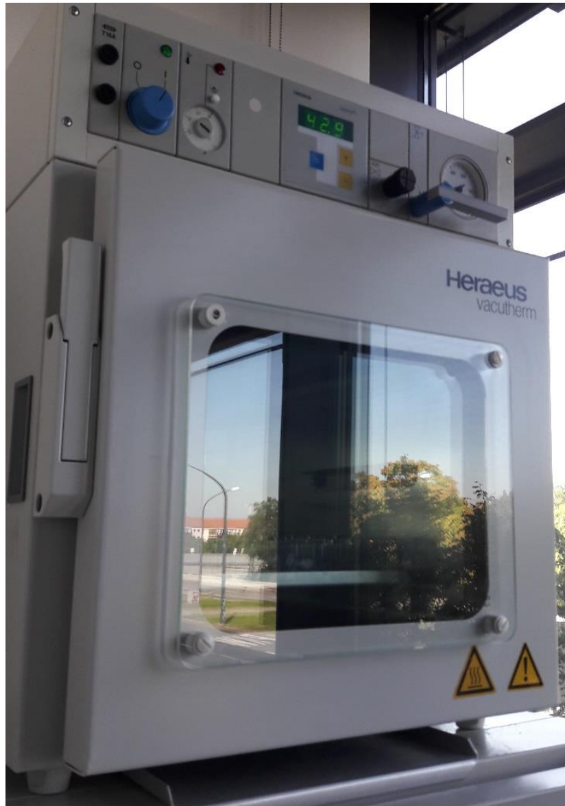
Figura 48. Estufa al vacío utilizado para secado de hidrogeles, Laboratorio de Polímeros Bioactivos y Sensibles del IPF.
