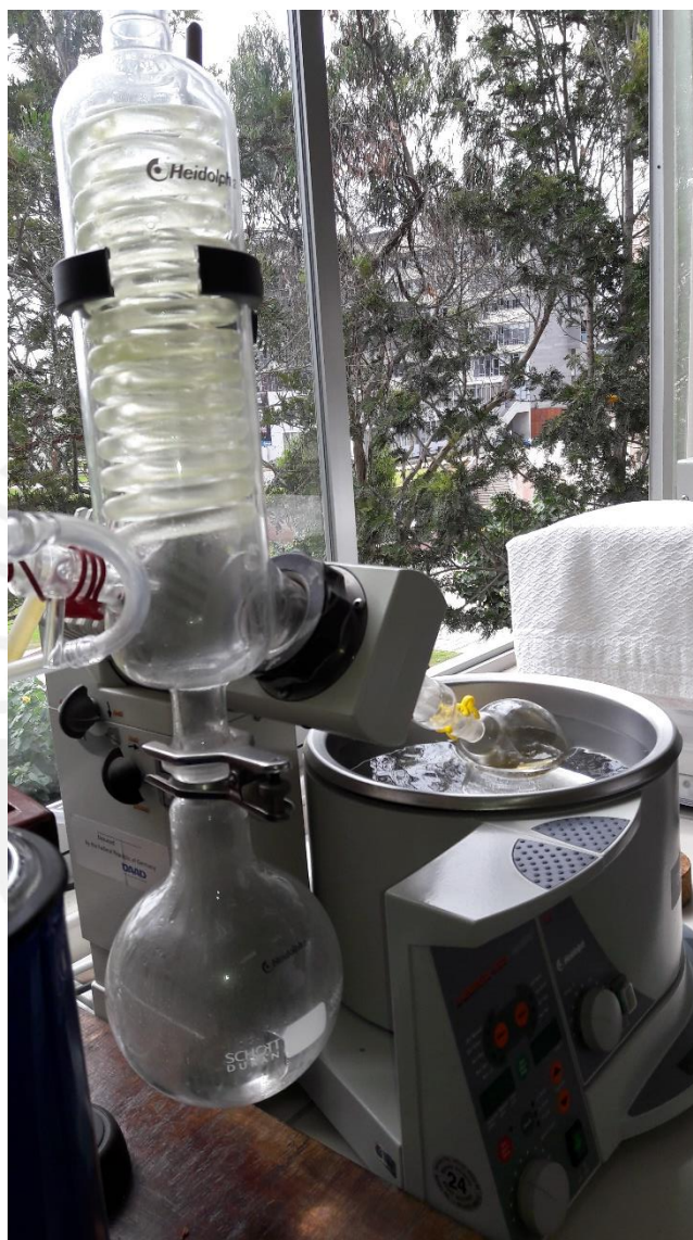
Figura 37. Evaporador rotatorio utilizado para purificar el monómero y macromonómero, Laboratorio de Polímeros Sección Física PUCP.
