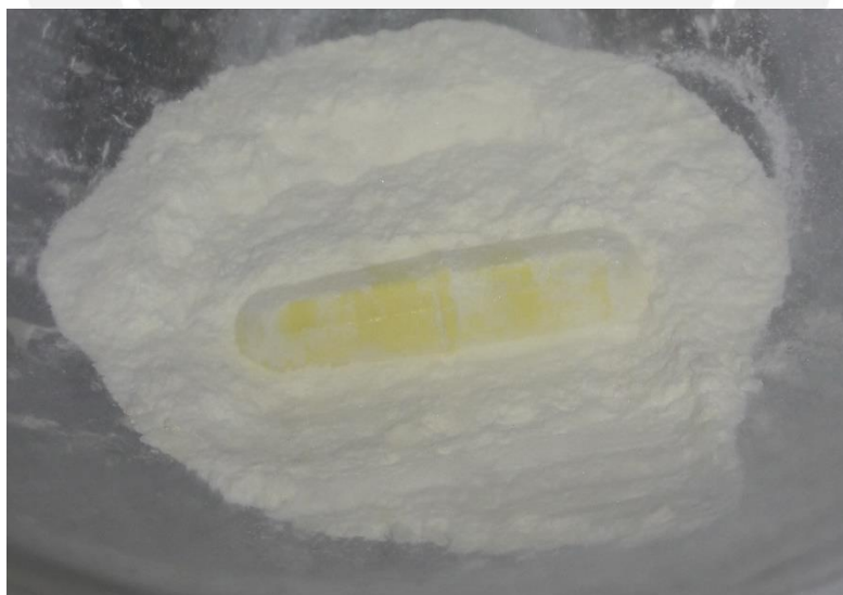
Figura 41. Macromonómero de Poli(2-ciclopropil-2-oxazolina) purificado y seco, Laboratorio de Polímeros Sección Física PUCP.
