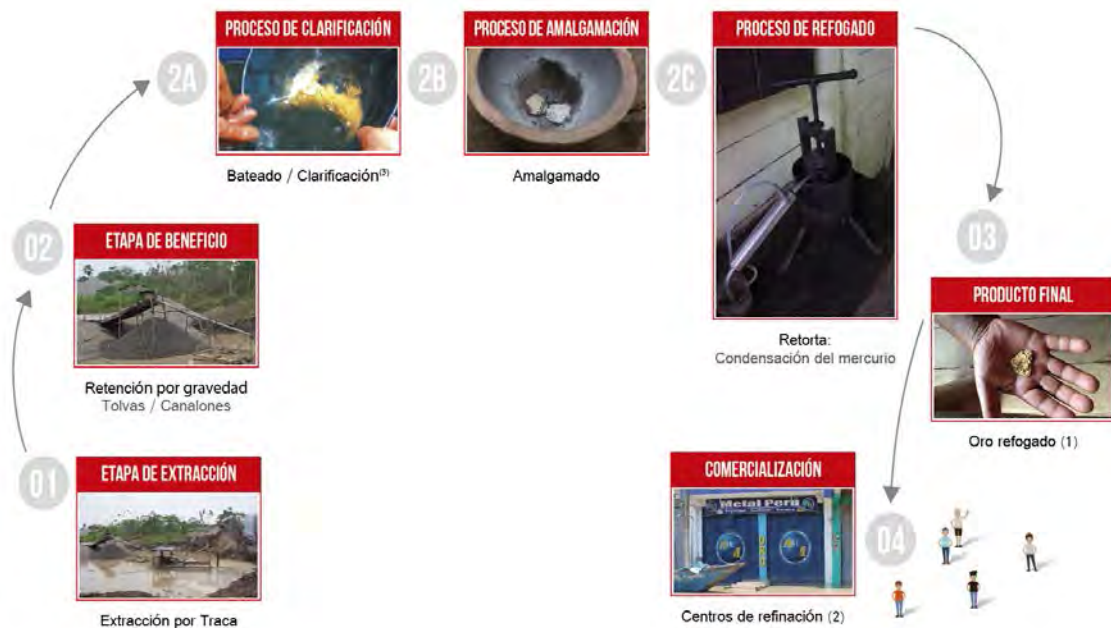
Figura 5. Proceso de extracción aurífera en Fortuna (Fuente: elaboración propia. La imagen (1) fue tomada de http://ilprofessorechos.blogspot.pe/2015/01/la-corsa-alloro-senza-scrupoli.html y la imagen (2) fue tomada de http://img.inforegion.pe.s3.amazonaws.com/wp-content/uploads/2014/02/Foto-Laberinto-10.jpg ).
