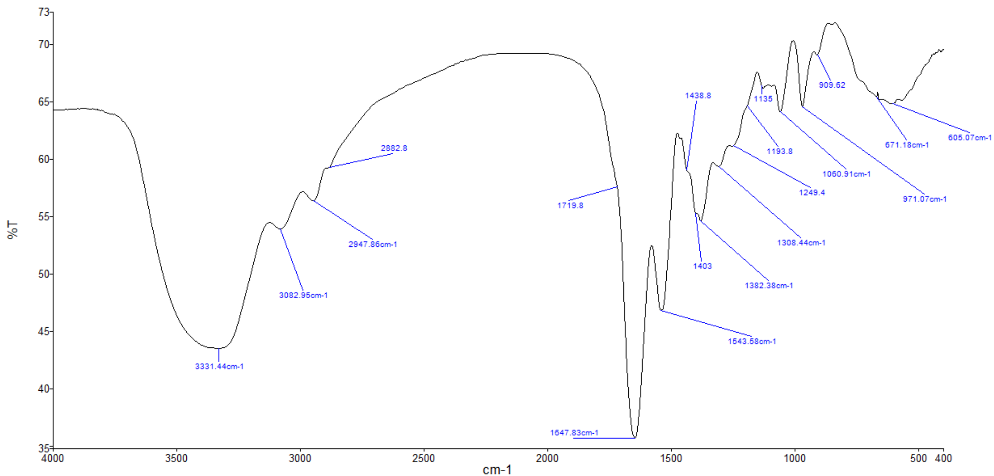
Figura 56. Espectro IR del sólido precipitado con acetona del conjugado 2E sintetizado a partir del PASP-DC-MC-MH-6 con un porcentaje teórico de 50% de PASP-MA y relación molar 2:1 DC:VO en KBr
