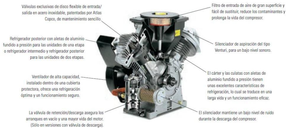
Figura 2.8: Esquema en corte de un compresor de émbolo oscilante Atlas Copco.
