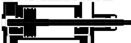
Figura 2.4: Esquema del actuador con la brida posterior modificada.
