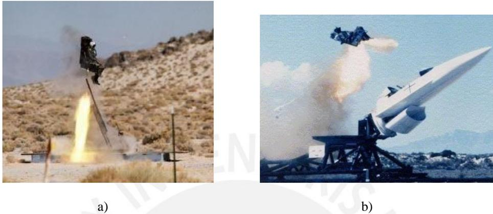
Figura 1.1: Simuladores que usan cartuchos pirotécnicos para la impulsión.
