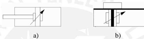
Figura 1.4: Ejemplos de símbolos normalizados para representar actuadores neumáticos.
