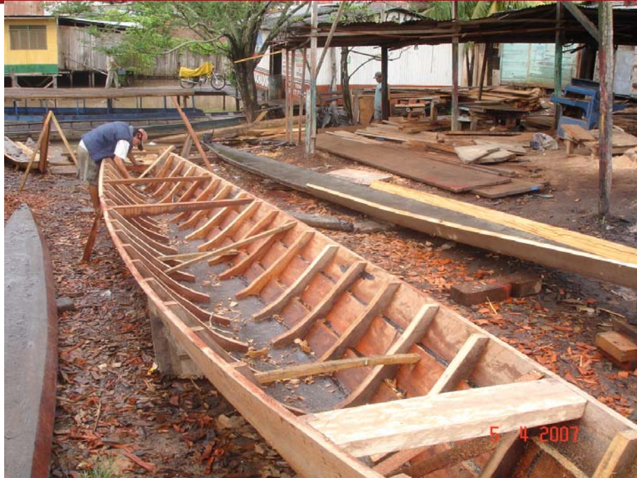
Figura 1.2. Fabricación artesanal embarcaciones Peque Peque
