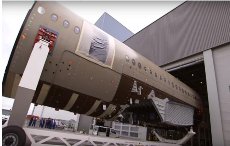
Figura 5 Estructura del avión fabricado con fibra de carbono (DesignStudios 5555, 2012)
