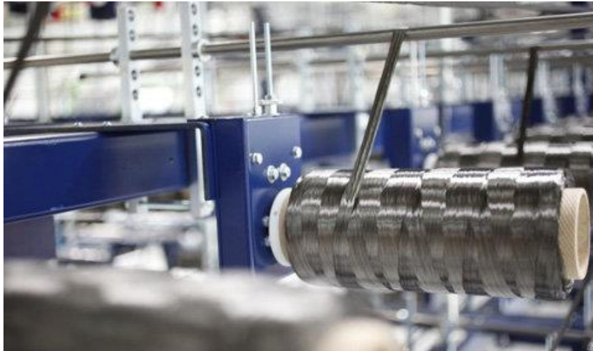
Figura 3 Fibra de carbono utilizado en la fabricación de los autos BMW (BBC Mundo, 2014)
