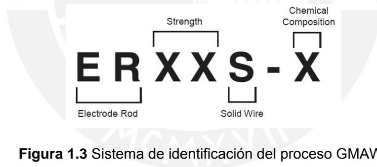
**Figura 1.3** Sistema de identificación del proceso GMAW [3].
