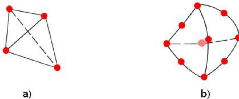
**Figura 3.9** a) Elemento sólido lineal, b) Elemento sólido parabólico
