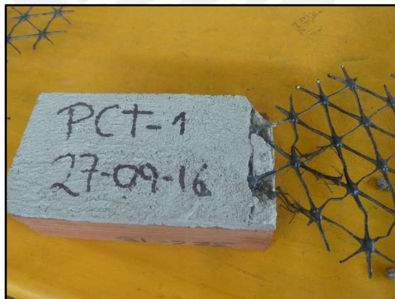
Figura 4.17 – Tipo de falla del espécimen PCT-1N
