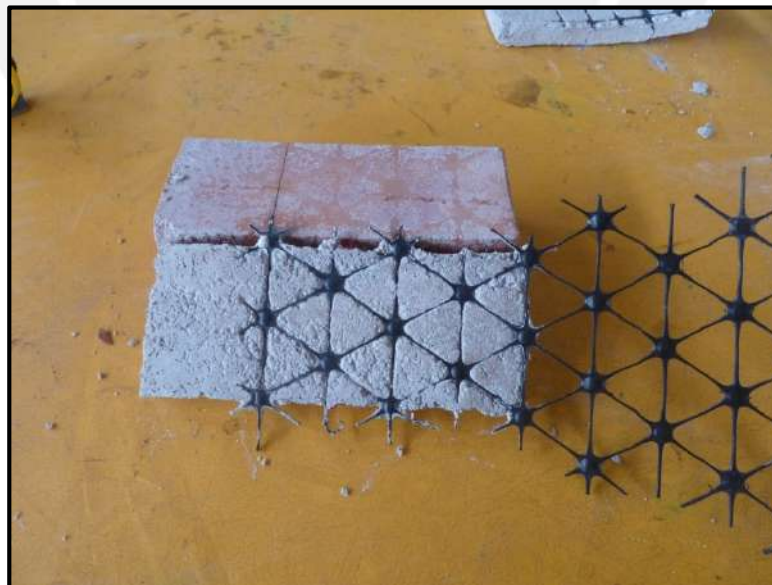
Figura 4.6 – Tipo de falla del espécimen KCT-1
