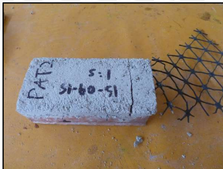
Figura 4.14 – Tipo de falla del espécimen PAT-2
