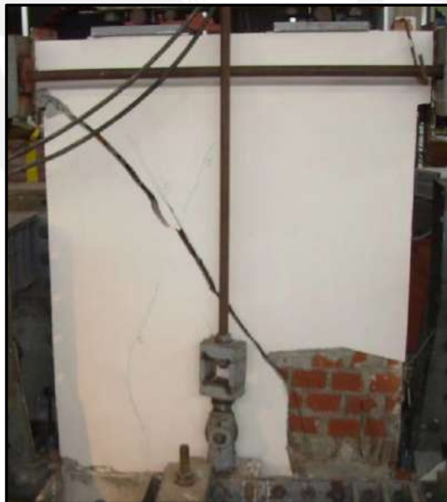
Figura 1.3 – Ensayo cíclico corte-compresión sobre muro tarrajado (Torrealva, 2015)
