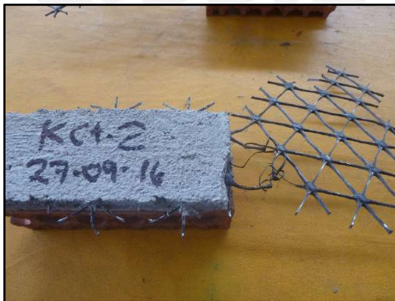
Figura 4.16 – Tipo de falla del espécimen KCT-2 N
