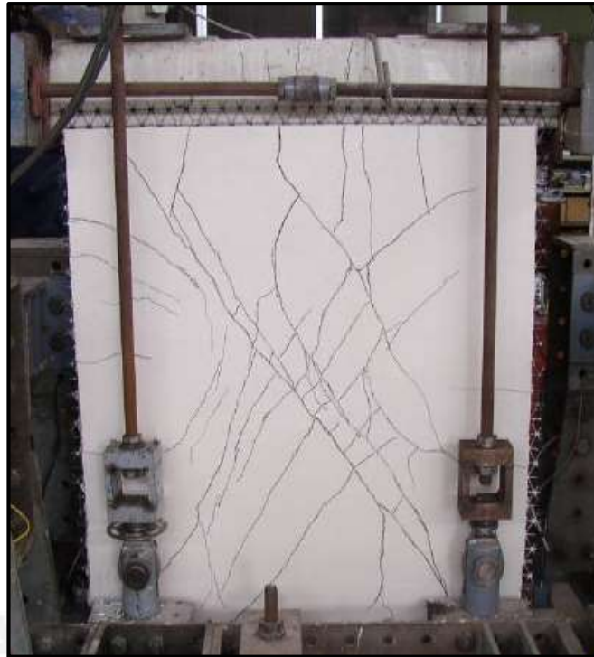
Figura 1.4 – Ensayo cíclico corte-compresión sobre muro reforzado-tarrajado (Torrealva, 2015)
