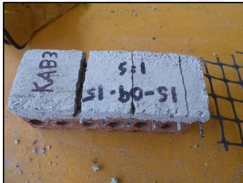
Figura 4.13 – Tipo de falla del espécimen KAB-3
