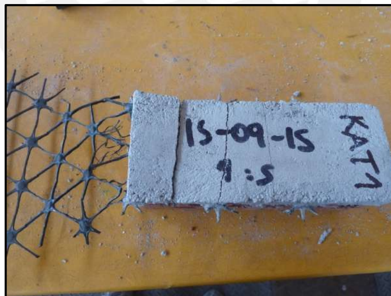
Figura 4.12 – Tipo de falla del espécimen KAT-1
