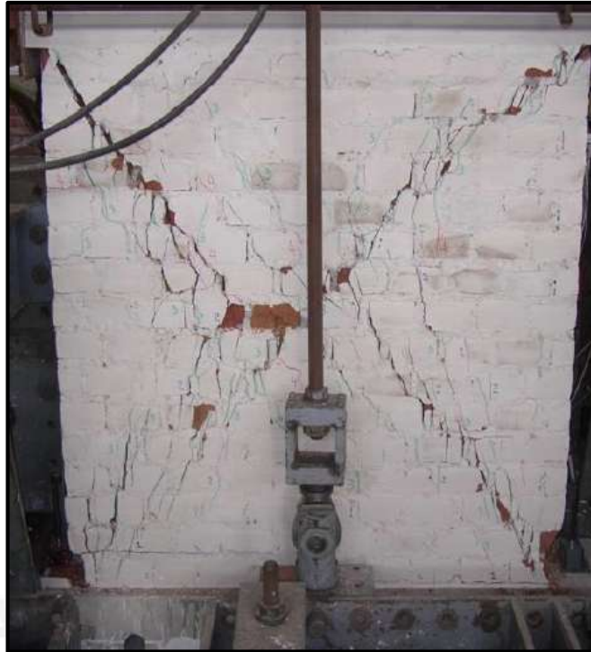
Figura 1.2 - Ensayo cíclico corte-compresión sobre muro simple (Torrealva, 2015)
