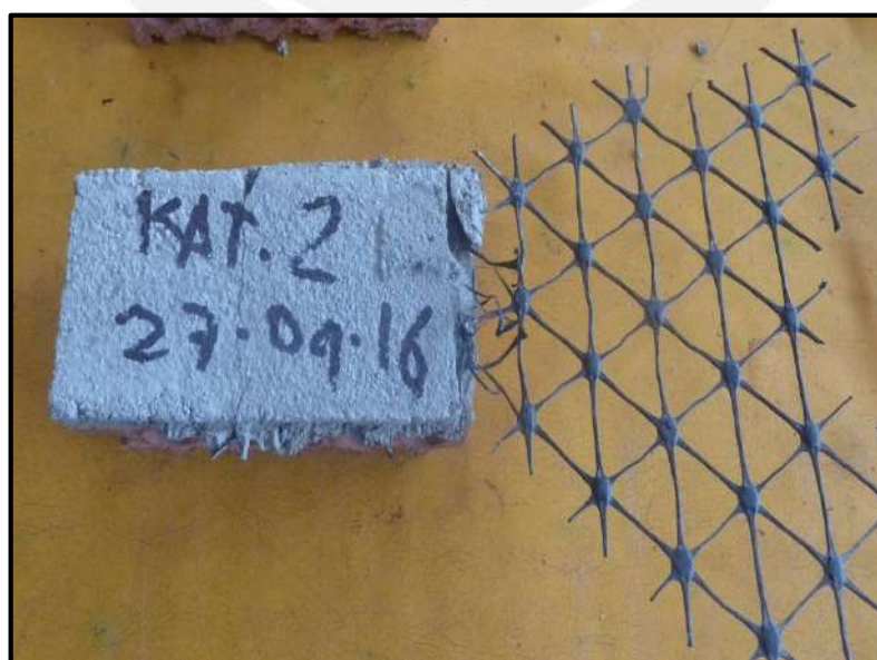
Figura 4.18 – Tipo de falla del espécimen KAT-2 N
