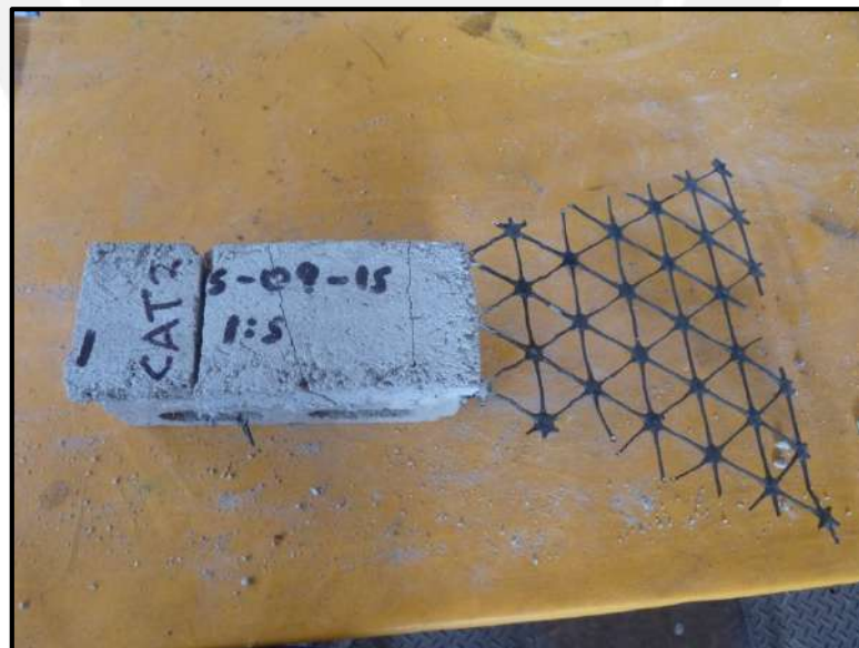
Figura 4.10 – Tipo de falla del espécimen CAT-2
