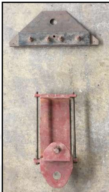
Figura 3.21 – Dispositivo de soporte (superior y base) de espécimen de adherencia
