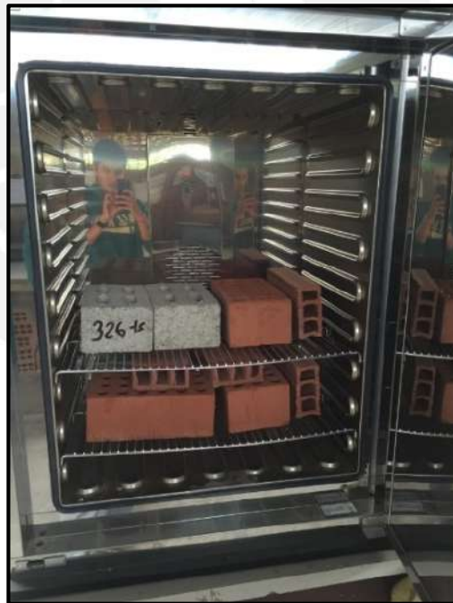
Figura 3.1 - Secado de unidades de albañilería en un horno de temperatura controlada
