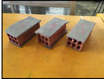
Figura 3.3 – Capping en los ladrillos pandereta
