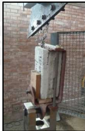
Figura 4.3 – Modo de falla al finalizar el ensayo
