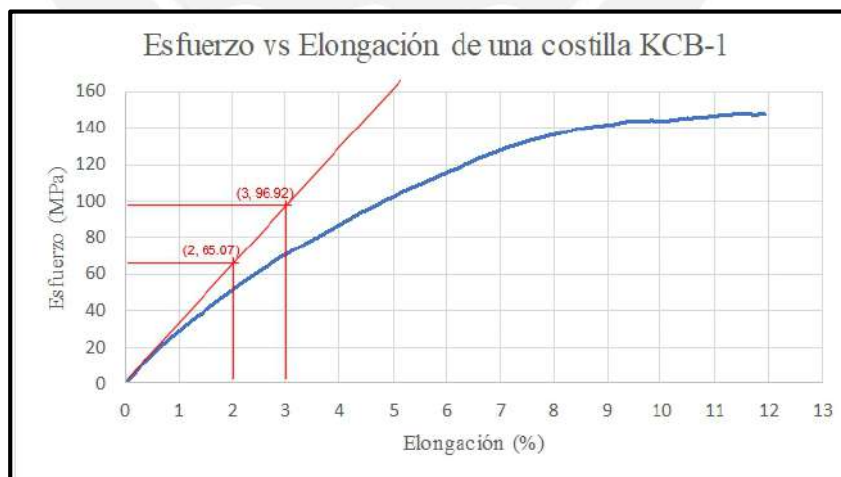
Gráfico 4.1 (continuación) – Curva esfuerzo vs elongación de los siguientes especímenes: (a.) Ladrillo Pandereta, mortero con cal y geomalla biaxial (PCB-1) (b.) PCB-2 (c.) Ladrillo King Kong, mortero con cal y geomalla biaxial (KCB-1)
