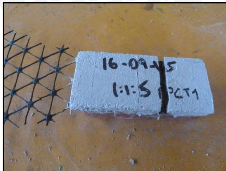
Figura 4.8 – Tipo de falla del espécimen PCT-1
