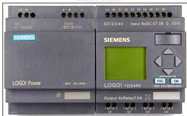
Figura 28: Micro-PLC LOGO, del fabricante SIEMENS.
