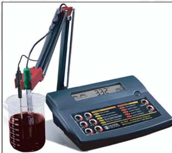
Figura 5: pHmetro, equipo electrónico que se utiliza para medir los valores de pH de cualquier sustancia, además nos indica temperatura.
