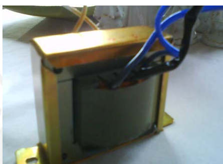
Fig. 4.4 Transformador 12 0 12 a 2 Amperios
