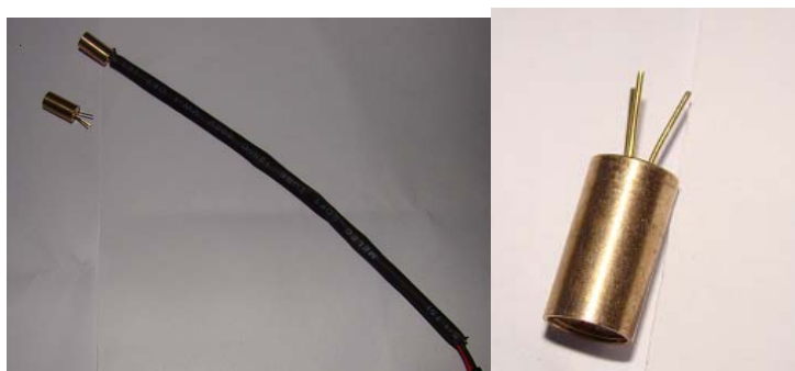
Fig. 4.10 Diodo Láser de 3 mW de luz visible roja
