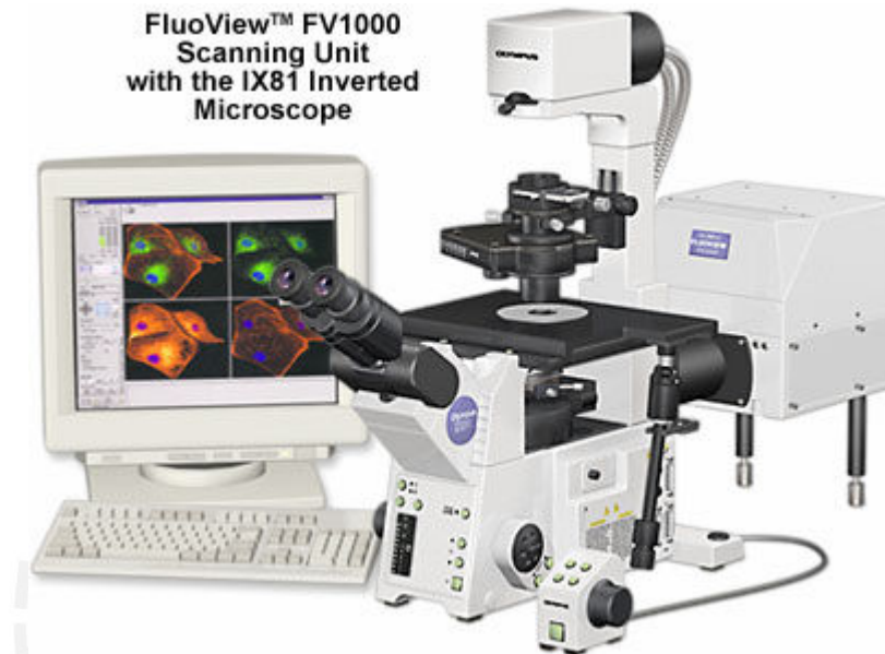
Fig. 1.6 Microscopio Confocal FlouView&TRade 1000 de la Compañía Olympus
