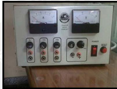
Figura 4.5: Fuente de Poder con voltaje regulable.
