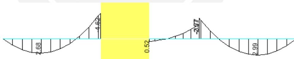
**Figura 5.15** Diagrama de momento flector carga viva. Viga VT-06
